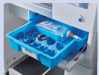
トレイ取出口 (装填台側) 調製後にストックされたトレイは、施用を選択して1つずつ鑑査するか、一括鑑査を行って装填台側から取り出すことが可能です。
