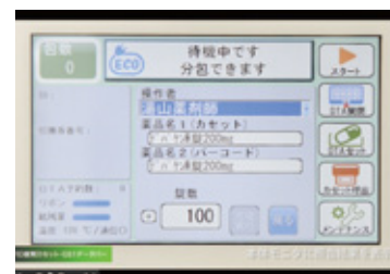
カセットのRFIDと薬品のGS1データバーでダブルチェック
